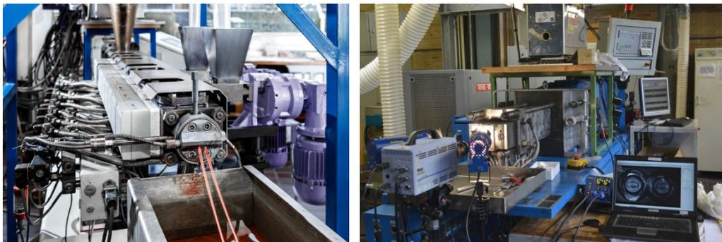
Links: Innovative Messtechniken geben einen Einblick, welche Mechanismen beim Anschmelzen und dem damit verbundenen Energieeintrag in die Schmelzzone von Doppelschneckenextrudern wirken.
